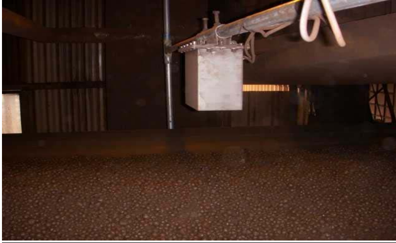
上图：铁矿石水分检测
