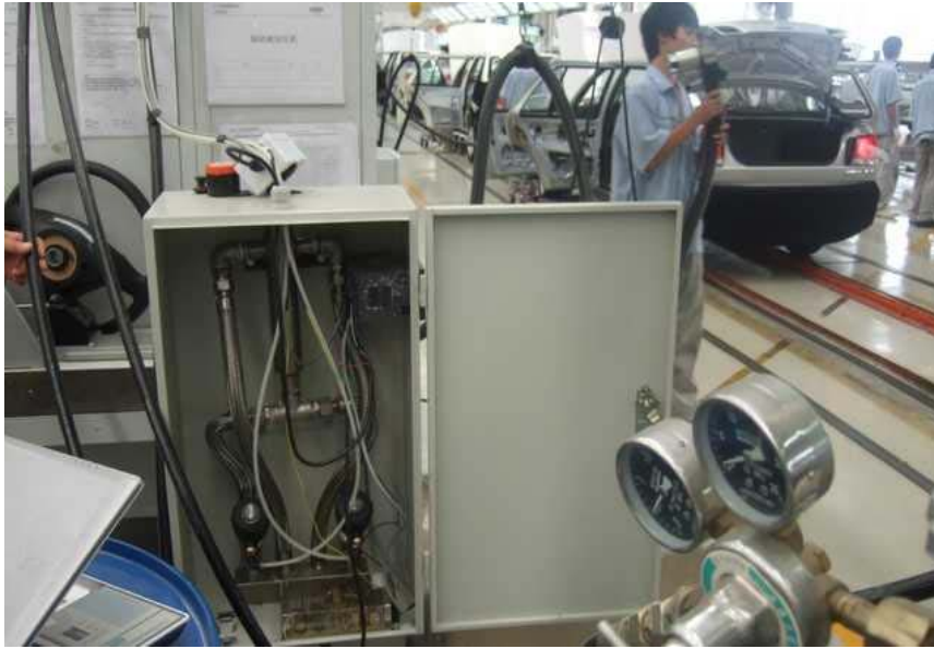
上图：一汽大众刹车油水分检测，0-0.5%量程
