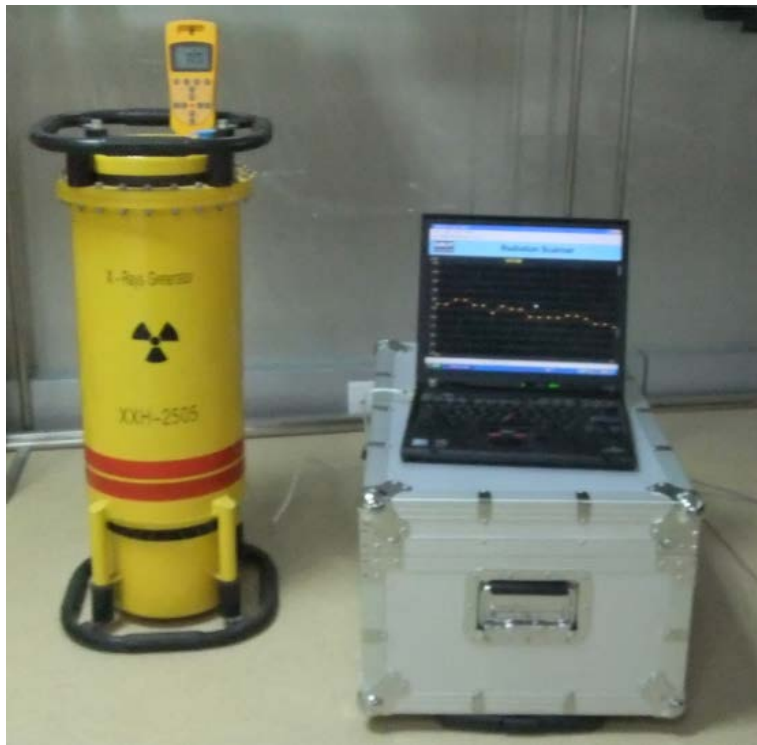
900 核射线仪连接电脑, 可通过电脑查看和记录辐射强度趋势
