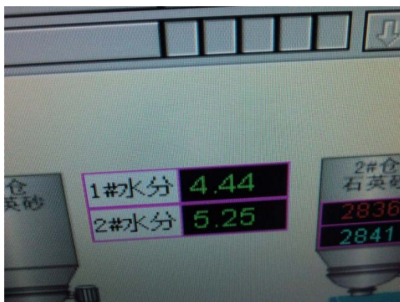
计算机控制面板上直接显示实时水分值
